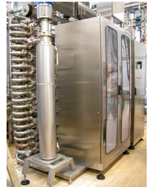
Stérilisateur de concentrés de légumes avec échangeurs à barrières de vapeur et 3 étages ohmiques (150 KW)
